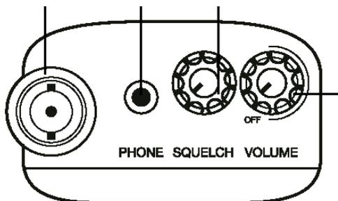
Damit vermeiden Sie das stromfressende und nervtötende Rauschen beim Bereitschaftsempfang auf einer unbenutzten Frequenz. Des Weiteren startet der automatische Suchlauf nur bei „geschlossener“ Squelch und stoppt nur dann, wenn ein Signal empfangen wird, das die mit Regler **SQUELCH** eingestellte Schwelle überschreitet.
