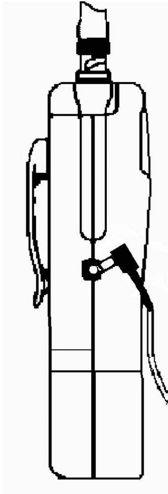
Das Netzteil wird mit einem Hohlstecker (Durchmesser: 3,8 mm außen, 1,35 mm innen) an die Buchse **DC 12 V PWR** angeschlossen.
